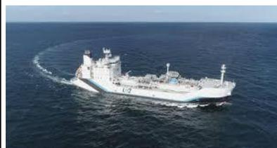
・水素サプライチェーン構築に向けて、パイロット実証で、**川崎重工業が建造した液化水素運搬船をShell社のグループ会社STASCO**（Shell International Trading and Shipping Company Limited）**が運行**。
